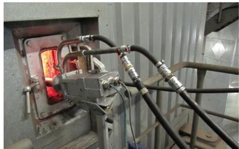
Abb. 4 und 5: Im Messeinsatz befindliches NIR-Thermografiemesssystem (mobil oder stationär)
