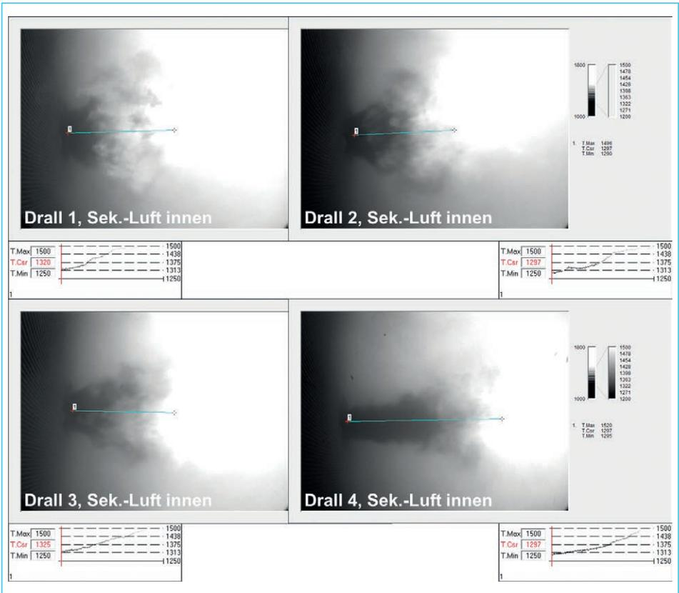
Abb. 8: Drallbrennertyp Beispiel 2; Variation des Drallwinkels und des Impulses der inneren Sekundärluft, Einfluss auf die Ausbildung der Zündbereiche und Flammenform
