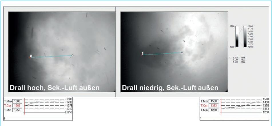
Abb. 7: Drallbrennertyp Beispiel 2; Variation des Drallwinkels der äußeren Sekundärluft, Einfluss auf die Ausbildung der Zündbereiche und Flammenform
