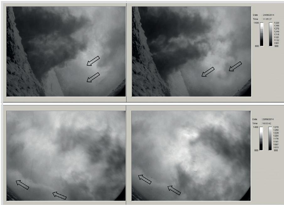
Bild 9. Lokalisierung von Wandberührungen der Brennerflammen an der Rückwand.
