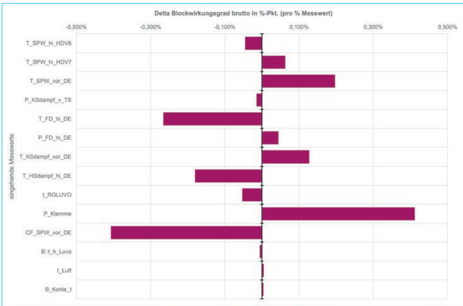
Abb. 2: Sensitivitätsanalyse für den Ist-Bruttowirkungsgrad
